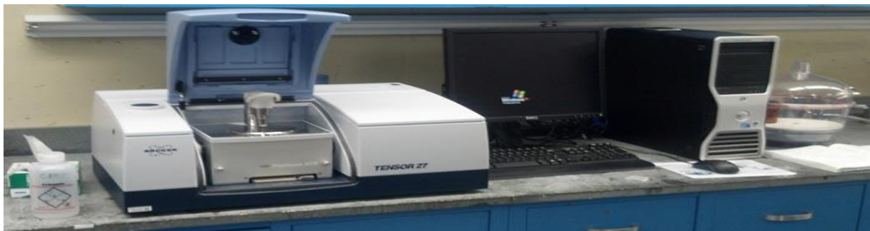
Figura 5.1: Spectrometer Bruker Tensor 27 ATR device system.
