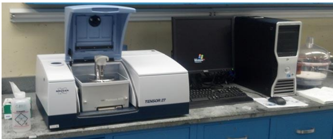
Figura 4.1: Spektrometer Bruker Tensor 27 me sistemin ATR (ATR-FTIR)
